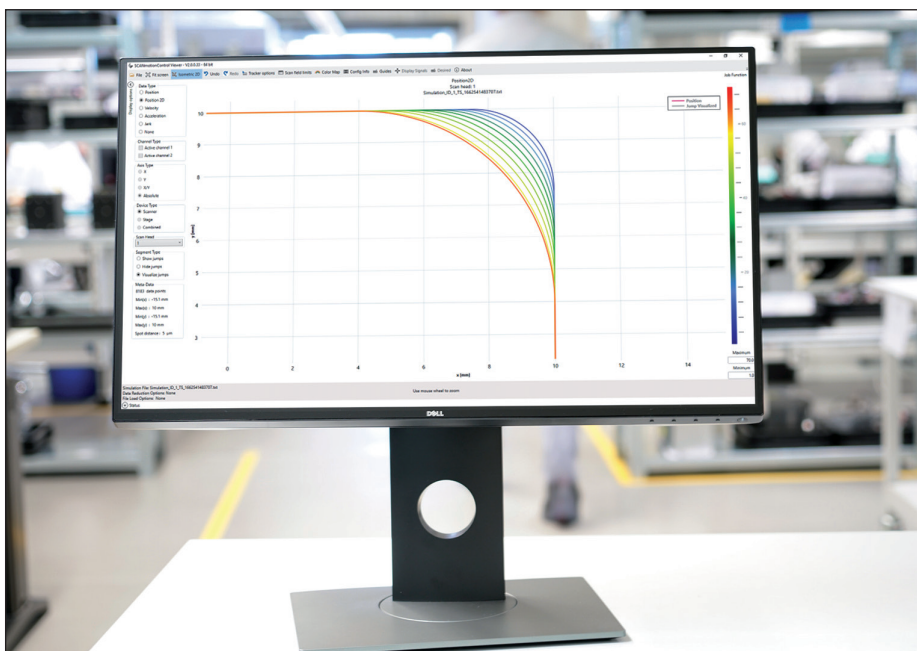
▲ Abb. 2: Simulation fahrbarer Bahnen bei vorgegebenen Parametern für die Konturtreue und Markiergeschwindigkeit.
