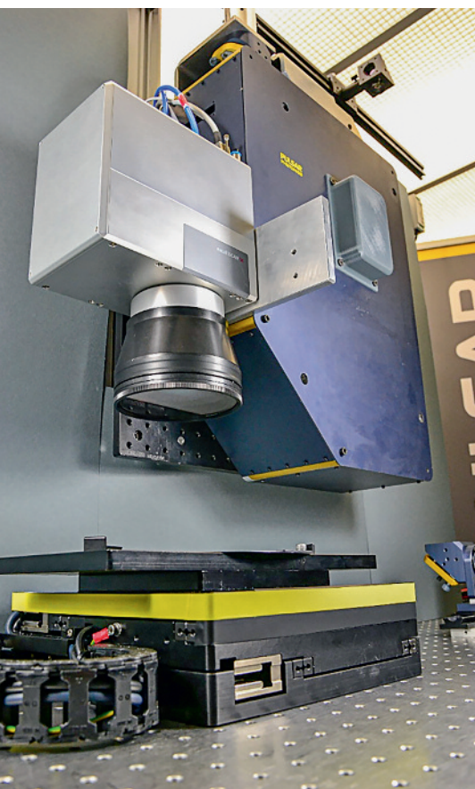
Bild 4. Laboraufbau zur Multistrahlbearbeitung mit »XL Scan« (»excelli-Scan 14«, Kreuztisch und Multistrahl-system von Pulsar Photonics)
